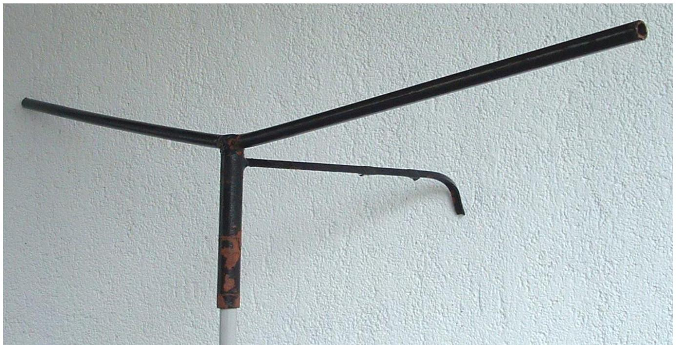
Na stranice nosača stavljeni su segmenti pripadajuće duljine od električarske plastične cijevi.
