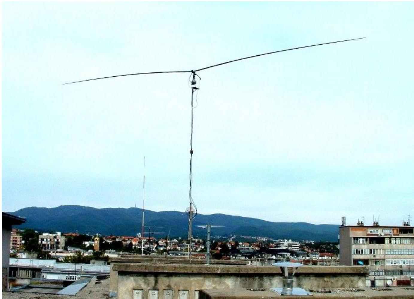
Podešavanje antene je jednostavno. Početna dužina dipola neka bude  $145 \text{ } 000/\text{frekvencija}$ . Pomoću odašiljača, pri smanjenoj snazi, uz korištenje SWR metra, izmjeri se rezonantna frekvencija. Željeni rezultat dobije se prostim skraćivanjem dipola. U središtu rezonancije SWR je  $1 : 1,1$ . Gledajući čitave opsege, SWR je uvijek bolji od  $1 : 1,4$ .
