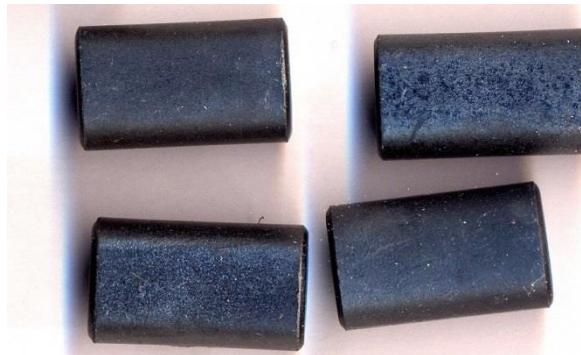
Materijal izrade : feritne valjkaste perle 4 kom., dvije ispiljene cjevčice od teleskopske antene, ostalo prema slici. Dužina ispiljene cjevčice = dužina 2 valjka + 5mm. Promjer cjevčice : što sličniji rupi na perli. Na krajevima uobičajeno dolazi kaširani pertinaks ili još bolje vitroplast, kao na slikama. Feriti su međusobno ljepljeni s dvokomponentnim ljepilom.
