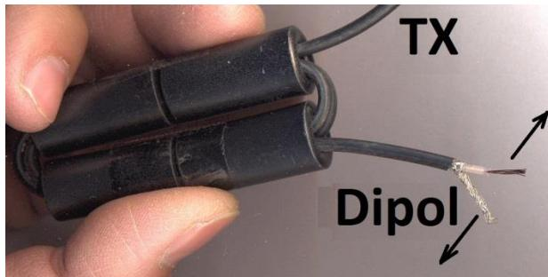
**RG174** s 3 navoja na perlama unutarnjeg promjera 5mm
